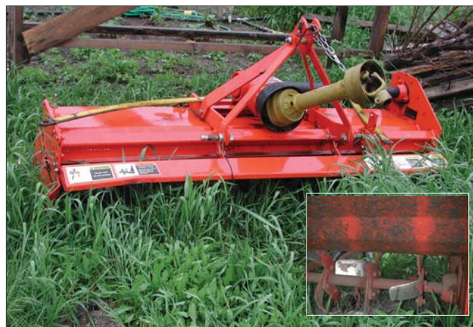
Le rotoculteur permet de détruire les rhizomes à une profondeur de 5-10 cm (photo : Daniel Cloutier)
