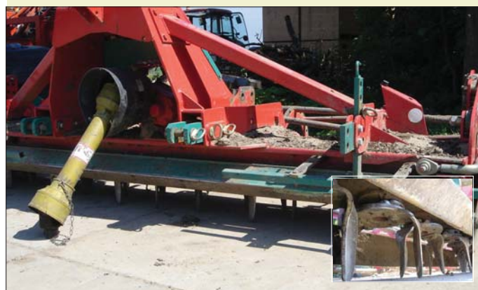
Le cultivateur rotatif permet de détruire les rhizomes jusqu'à une profondeur de 25 cm (Photo : Ghislain Jutras)
